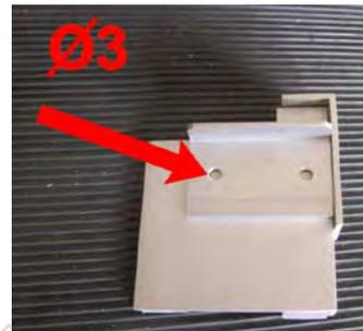
Sur le dessus, percer le trou de gauche au Ø3 et fraiser le dessous. Le trou de droite sera percé au Ø2 seulement (uniquement l'aluminium). A gauche, utiliser un boulon M3 qui sera coupé au ras de l'écrou et limé. A droite, utiliser une vis de 2x10.
