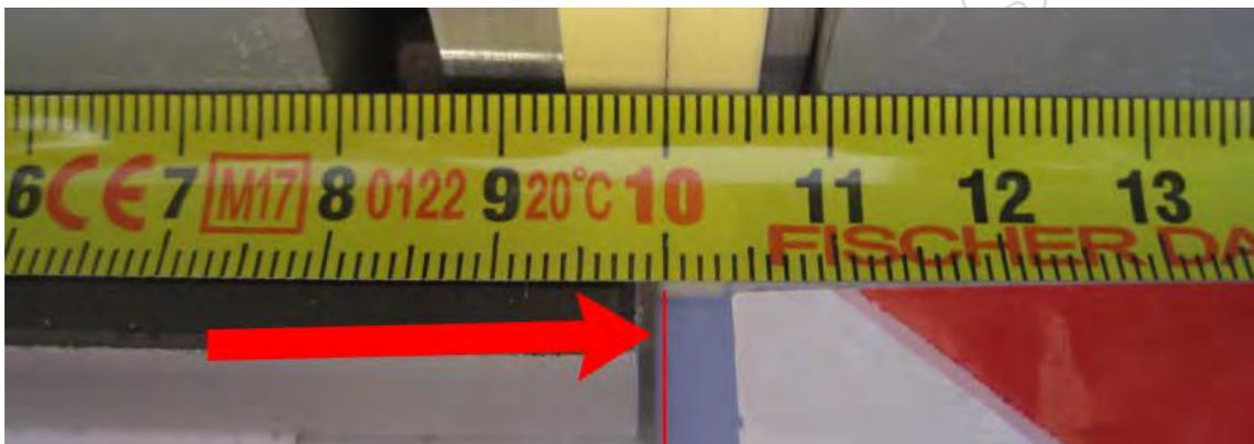
Effectuer une coupe d'essai, avec une chute, sur une dimension de 40 par exemple. Mesurer le résultat obtenu au pied à coulisse. Retoucher le réglage jusqu'à obtenir satisfaction, toujours sur de petites dimensions, vérifiables au pied à coulisse.
