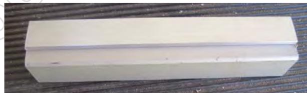
Comme pour le précédent, débiter un morceau de 90 dans un carré d'aluminium de 15 x 15. Remplir l'intérieur avec un tasseau de bois, puis sur une extrémité, tracer les deux diagonales et percer au milieu de l'une d'elles un trou Ø2 de 20 de profondeur. Débiter un morceau de 90 également dans un plat d'aluminium de 10 x 2 et le coller au double face sur le carré, affleurant sur le dessus.
