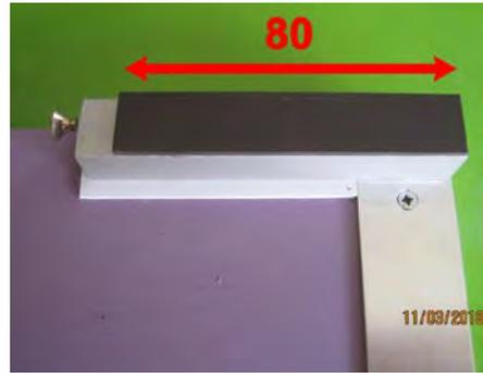
Pour réaliser le curseur, débiter un morceau de 60 dans une cornière en aluminium de 55 x 20. Ramener son petit côté à 12 et découper l'angle supérieur gauche selon le schéma :
