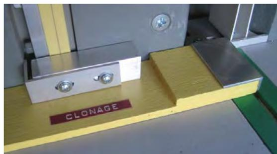
Elle sert à reproduire une dimension à l'identique, sans mesurer. Son principe est simple : il suffit d'aligner le côté droit de la cale avec les dents de la scie également sur le côté droit. Sa mise en place s'appuie sur l'encoche du guide gauche. Elle est fermement maintenue par une pince à droite
