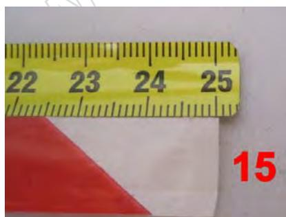
En ce qui concerne le morceau de mètre de 13 de largeur, couper à la graduation 252 (visible). Tirer le crochet et le bloquer en tapant sur ses rivets avec un pointeau.
