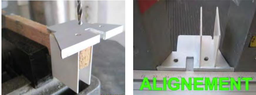
Aligner soigneusement la pièce sur les deux guides latéraux, en positionnant l'ensemble avec une règle, puis boulonner (M3), vérifier, bloquer.
