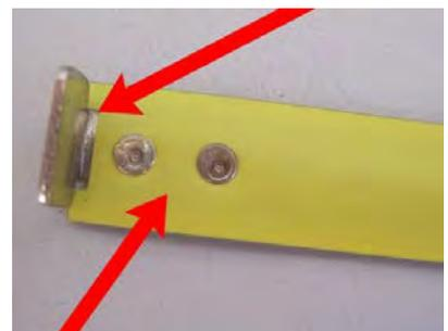
Ajouter un morceau de bande de signalisation rouge et blanche, « scotché » au verso en bas de 15 de hauteur ; il attire l'attention pour bien penser à retirer le mètre avant la coupe... Enfin, coller une étiquette au Dymo indiquant la capacité de coupe (20/230) sur le curseur.
