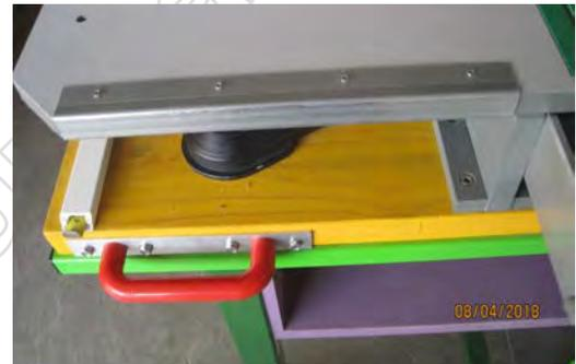
J'ai utilisé une cornière métallique pour cloisons de plaques de plâtre coupée en deux dans le sens de la longueur. On obtient ainsi une «cornière» de 20 x 17 avec un petit retour de 5 en dessous. Elle présente un léger bombé sur le dessus. Une cornière d'aluminium doit aussi convenir.
