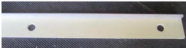
Fraiser le dessus (intérieur de la cornière), profondément (les vis de fixation ne doivent en aucun cas dépasser). *A la réflexion, un perçage au diamètre 6 semble suffisant, avec un écrou à frapper M6, évidemment.*
