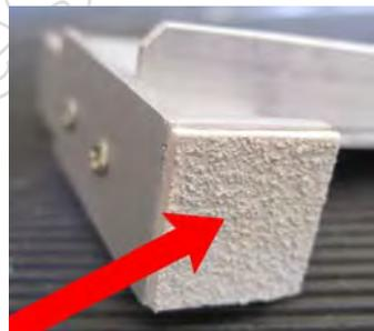
Sur le côté, percer au Ø2 (seulement les deux épaisseurs d'aluminium), puis visser (vis 2x10). Sur le devant, coller un morceau d'antidérapant pour bateau de 15 x 15.
