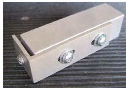
Couper la première vis à gauche à 10 pour éviter un conflit avec la vis du ressort. Remonter la cornière en utilisant des petites rondelles de  $\varnothing 8$  extérieur.
