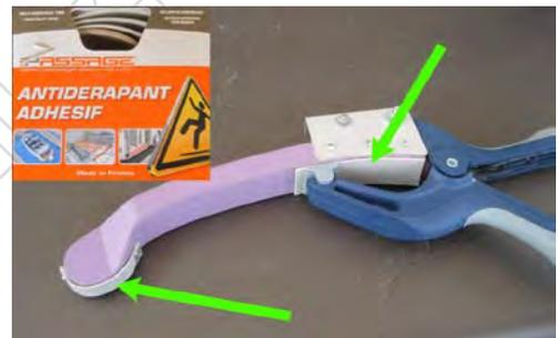
Pour l'avant, débiter un morceau d'antidérapant de 75 x 10 au cutter. Dans une cornière en aluminium de 10 x 10, débiter deux morceaux de 10. Ramener un côté à 2 (épaisseur de l'adhésif). Sur l'autre, percer un trou central au  $\varnothing 2$ , selon le schéma :
