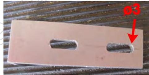
Positionner la cornière avec une vis de 3x20 à tête bombée. Il faut la visser jusqu'à mi-course de la compression du ressort. Marquer sur le côté l'emplacement des deux trous oblongs et percer en leur centre au  $\varnothing 2$ . Visser à blanc deux vis de 2,5x15 dans le tube carré pour former le trou.
