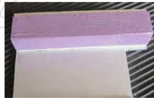
PVC de 1,5, débiter un morceau de 50 x 15 et le coller au double face de l'autre côté. L'intervalle de 25 correspond à la largeur de la cornière : vérifier que la pièce coulisse sans forcer, mais sans jeu. Le PVC est légèrement en retrait de l'aluminium flèche rouge).
