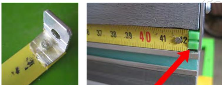
Pour fabriquer cette dernière, débiter un morceau de 30 dans une cornière d'aluminium de 20 x 10. Au verso, tracer l'épaisseur, puis percer un trou Ø3,5 centré, à 10 du bord gauche (photo).
