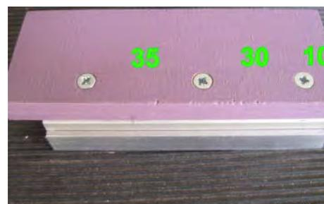
Dans une cornière en aluminium de 40 x 20, débiter un morceau de 24, puis façonner la pièce d'après le schéma :
