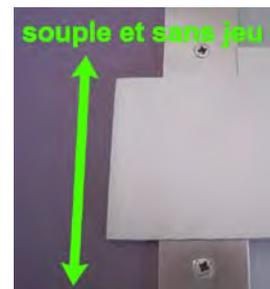
Cornière aluminium de 40 x 15, débiter un morceau de 18 et percer deux trous au Ø3 selon le schéma :
