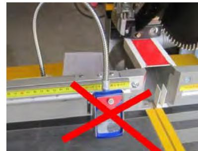
Le fait de regarder maintenant par le dessus permet de supprimer tout réglage optique. De plus, elle peut également être utilisée au-dessus du curseur droit. Elle est simplement posée à cheval sur le dessus de l'un des deux guides.
