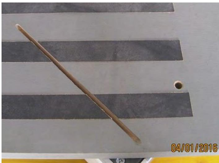
Mettre en marche et entailler doucement le plateau de bois. La lame va traverser au milieu de la fente. Descendre la lame lentement, à fond. On obtient une fente régulière qui permettra de ranger la lame dans cette position et ainsi de la protéger.
