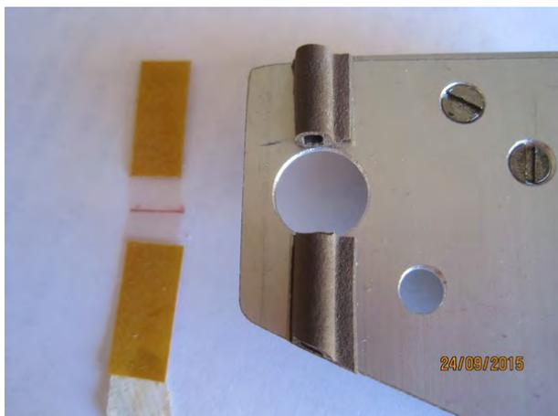
Placer deux petits morceaux de double face de part et d'autre de la rayure à 10mm.
