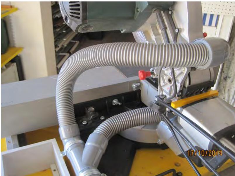
On va disposer d'une double aspiration en diamètre 40, celle d'origine au-dessus du carter et celle du collecteur qui sont reliés par un Y. Les flexibles seront récupérés sur un vieil aspirateur, en vérifiant qu'ils sont bien au diamètre 40.
