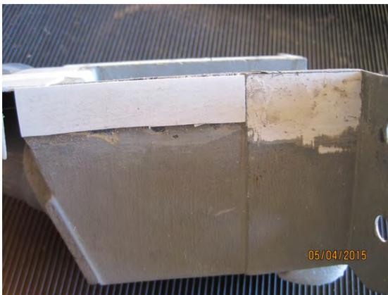
Débiter deux bandes de PVC de 65 x 15 dans un morceau de cornière 40 x 40 (pour avoir exactement la même épaisseur) et les coller en affleurement sur le haut des deux montants latéraux.
