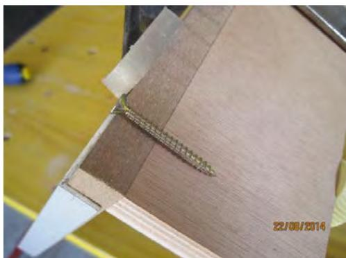
Les deux guides sont vissés (6 vis à gauche, 7 à droite) dans la partie horizontale avec des vis de 35.
