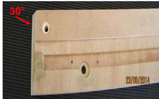
La rainure inférieure située à 20 du bas mesure 18 de largeur et 10 de profondeur. Elle est bouchée sur 20 à gauche. Percer  $\text{Ø}8$  et fraiser le trou. Coller (époxy) une vis 8 x 30 tête fraisée (la tête affleure le fond de la rainure). La rainure recevra un rail en aluminium en U (rail de rideau), qui sera vissé avec 9 vis réparties sur sa longueur.
