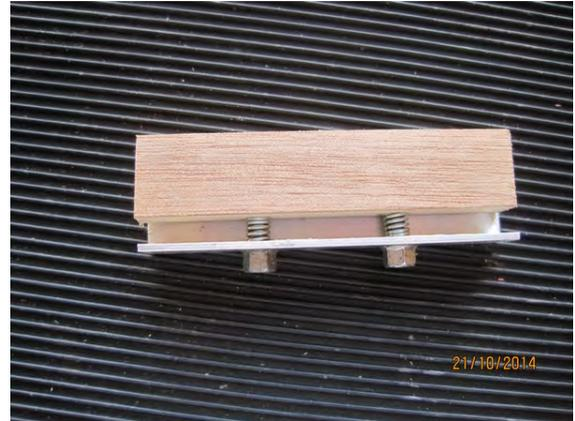
Démonter et peindre le bois. Découper un morceau de couverture de classeur en plastique de 80 x 20 et le coller au double face sur la cornière au 2/3 de sa largeur, couper l'excédent aux ciseaux. Visser la cornière sur le bois avec les ressorts à fond, puis desserrer d'un tour.
