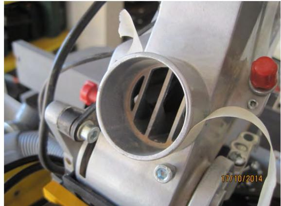
L'autre côté viendra directement se brancher sur la machine. Mais l'assemblage a un peu trop de jeu, le coude tourne trop facilement. C'est pourquoi, on enroulera autour de la sortie métallique du carter une bande de papier adhésif de 20 de hauteur ; un seul tour suffit. Le jeu est supprimé et le coude ne tourne plus en avançant et reculant la scie.
