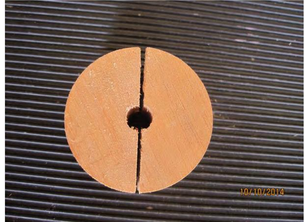
Sur la photo précédente, on en réalise deux à la fois. Toujours dans un CP de 20, découper un cercle  $\varnothing 45$  à la scie cloche et le couper en deux. Parfaire l'arrondi de l'arc à la râpe puis à la lime et coller le demi-cercle à une extrémité (colle à bois).
