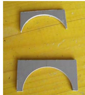
Ajuster leurs tailles à la lime : le petit se place à l'intérieur, sur le dessus ; le grand, en dessous, en bas. Lorsque les dimensions sont correctes, coller avec un fort filet de colle.
