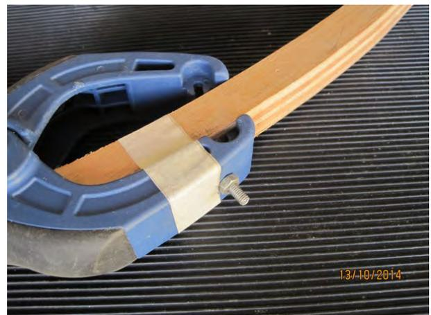
Percer un premier trou  $\varnothing 4,5$  à 20 de l'extrémité bien au centre et boulonner ( $\varnothing 4$ ). Percer un deuxième trou à 30 du premier. Démontez et fraiser les deux trous à l'intérieur. Remontez, coupez les vis au ras des écrous et limer.
