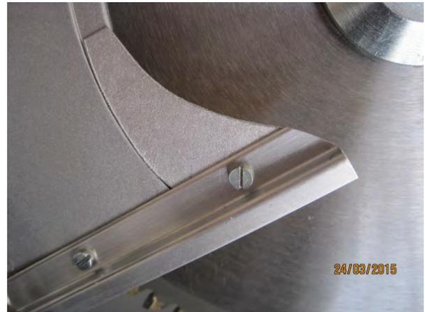
En haut, cette pièce est collée sur l'extérieur du carter dans le creux du bord de la tôle avec un petit morceau de double face. En bas, la pièce est boulonnée sur l'intérieur de la cornière. Utiliser un boulon 3 x 6 (à couper) muni d'une rondelle éventail pour bloquer l'écrou.
