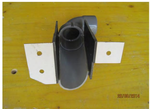
Placer la scie en position 90° et positionner le conduit d'aspiration entre les montants latéraux et sur le papier adhésif.
