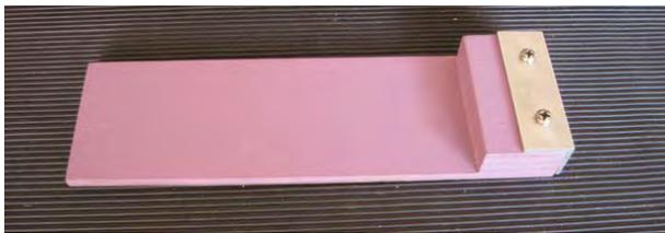
Vérifier l'équerrage de l'avant de la cale. Éventuellement, ajouter une cornière aluminium de 20 x 20 de 60 de longueur fixée avec deux vis. En dessous, coller du papier de verre grain 240 (antidérapant) sur toute la surface, araser les bords au cutter.
