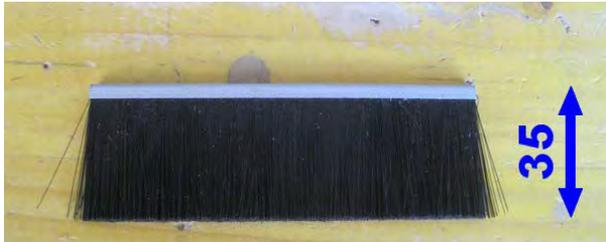
On utilise des balais pour bas de porte de garage (plus hauts que ceux pour les portes d'entrée), d'une hauteur de 35 mm.
