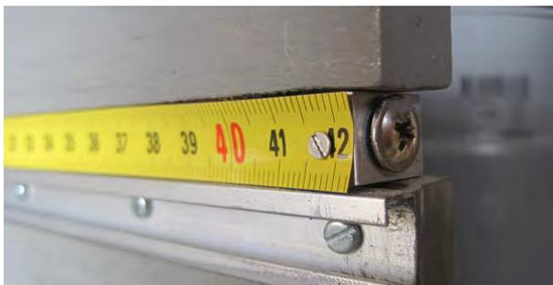
A son extrémité à droite, le ruban métallique est percé  $\text{Ø}2$  entre les graduations 41,5 et 42, une petite équerre (8 x 12) en aluminium est vissée dessous. Une vis 4 x 40, engagée dans l'épaisseur du bois, munie d'un ressort va permettre un réglage fin par glissement du mètre ruban sur le support magnétique.
