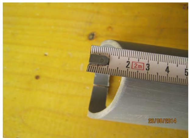
En face, réduire la longueur de la découpe à 90 en coupant l'arrondi inférieur de biais. A l'arrière, en dessous, couper en biseau sur une profondeur de 20. En dessus, ramener l'arceau supérieur à une largeur de 10 en coupant perpendiculairement, puis le fendre.
