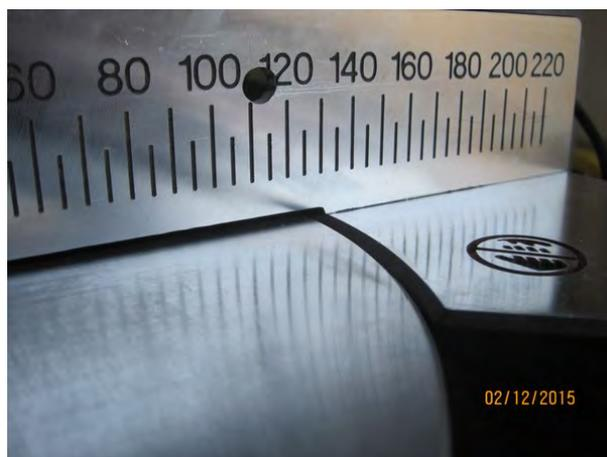
Perçer l'aluminium des deux guides d'origine au Ø8. Placer un adhésif papier à l'arrière pour éviter d'avoir des copeaux d'aluminium coincés dans le plateau mobile, et aspirer soigneusement tous les copeaux.
