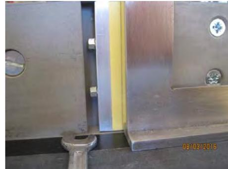
Visser les trois vis en veillant à l'affleurement du plat par rapport au guide sur le devant. Vérifier la verticalité de la rayure avec une équerre fiable et sa distance de 100 par rapport au côté gauche de la lame de scie.
