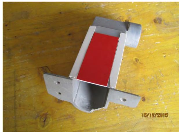
Elle se compose d'une sorte de "boîte" en forme de U, fermée sur le dessus par un volet coulissant. A l'arrière, un coude PVC Ø40 se branche directement sur l'aspiration.
