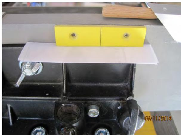
Vérifier que l'équerre sous le plateau est bien en place contre la table de la machine. ainsi que le serrage des 4 boulons de fixation du plateau. Sur le guide de la scie, coller au double face un petit morceau de mètre en papier en plaçant sa graduation centrale exactement en face du trait vertical du morceau de PVC.
