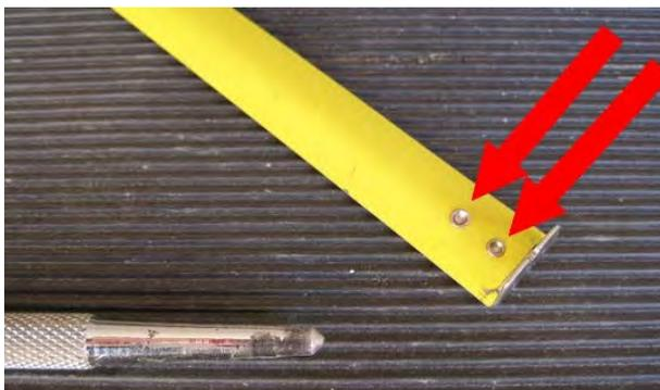
Il est préférable de fixer le crochet mobile du mètre en position extérieure ; pour cela, donner un léger coup de pointeau sur l'intérieur de ses deux rivets.
