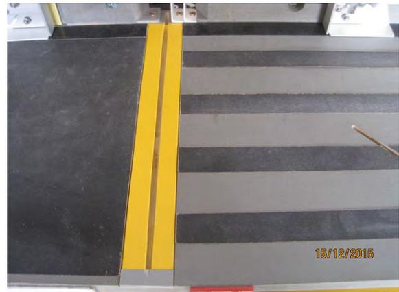
Du papier de verre de carrossier, grain 240, a été collé du côté gauche. Le même matériau est placé en bandes de 20 avec du double face du côté droit pour contrebalancer la sur-épaisseur. Pour la même raison, du ruban adhésif noir de 20 mm de large a été collé en haut à droite (en deux couches) pour permettre au curseur de glisser correctement.
