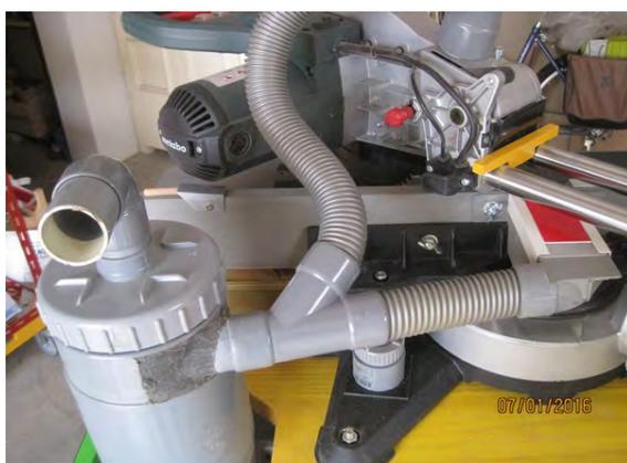
Avec le cyclone, le branchement est maintenant modifié au niveau du raccord en Y.
