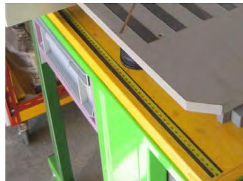
Sur le devant de la table du chariot, coller un morceau de ruban adhésif magnétique de 20 de large pour recevoir un morceau de mètre ruban de 780 (largeur du plateau).
