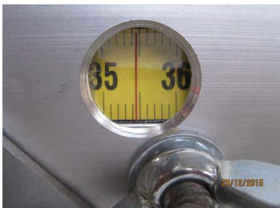
Vérifier le bon fonctionnement : le transparent doit épouser la forme en creux du mètre. L'ajustement doit être parfait, tout le reste en dépend. Couper l'excédent de part et d'autre avec des ciseaux.
