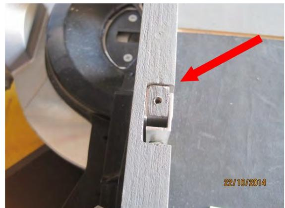
Coller avec du double face. Vérifier le bon fonctionnement : la cornière doit légèrement avancer ou reculer en tournant les vis avec une petite clé de 6.
