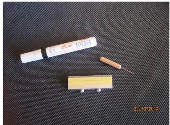
Mettre en place dans la rainure du guide, abaisser la lame de la scie, mesurer 100 et le marquer sur le plastique. L'enlever et rayer le plastique jaune sur ce repère avec l'aiguille d'un trait très fin bien parallèle (appuyer, passer deux ou trois fois).
