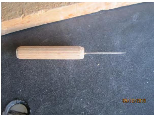
Prendre un tourillon Ø8. le percer verticalement à la perceuse à colonne sur une profondeur de 15 avec un foret Ø1. Tremper une aiguille dans de la colle époxy côté chas. Enfoncer l'aiguille dans le trou avec une pince, laisser sécher.
