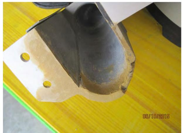
La pâte encore molle prend la forme des différentes pièces rencontrées. Après séchage et ponçage, on recommence l'opération plusieurs fois jusqu'à ce que l'on obtienne un contact très précis qui garantira une très bonne étanchéité à la poussière.
