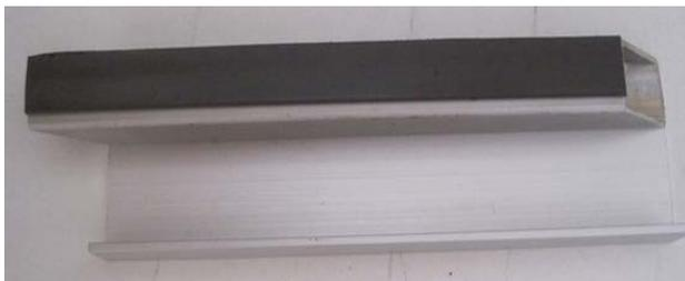
Sur le dessus du carré, placer un morceau de ruban magnétique adhésif 2 mm en retrait. Il est affleurant à l'arrière ; découper l'excédent au cutter.
