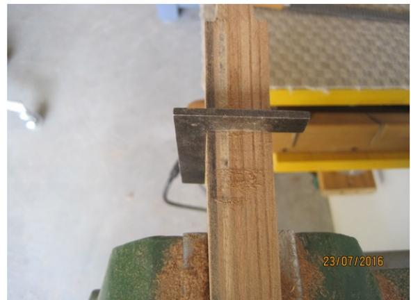
Le dessus et le dessous doivent être perpendiculaires aux côtés. Vérifier à l'aide d'une petite équerre.
