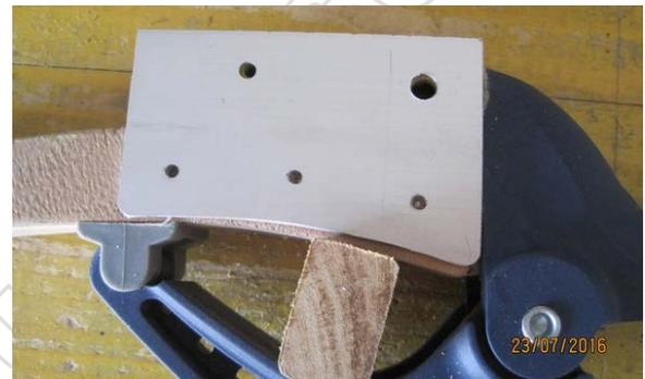
Dans les trois emplacements marqués, effectuer des avant-trous au  $\text{Ø}2$  sur 20 de profondeur.
