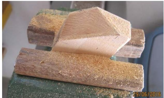
Présenter la pièce de bois sur l'extrémité droite de la cornière. Marquer l'emplacement des deux trous. Percer un avant-trou Ø1,5 profondeur 10 à l'arrière et Ø2 profondeur 20 en-dessous.
