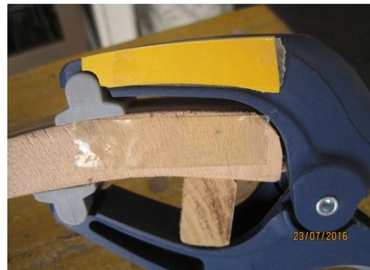
Pour les perçages supérieurs, coller au double face le PVC et la cornière aluminium sur la pince.
