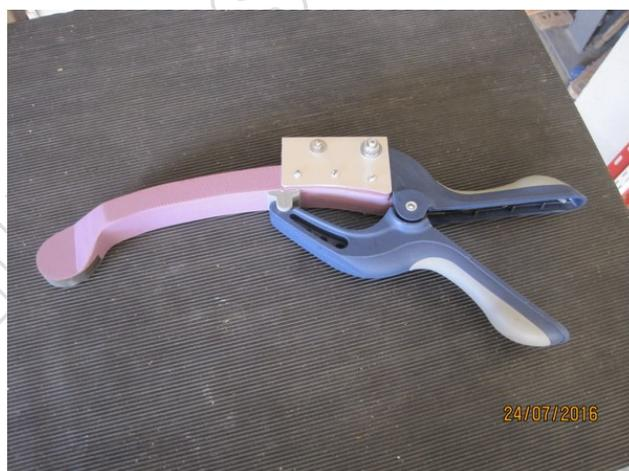
Commencer par débiter deux morceaux de CP de 14 d'épaisseur: un morceau de 280 x 60 et un morceau de 245 x 60. Les coller à la colle à bois pour obtenir une épaisseur de 28 (le petit morceau derrière le grand).
