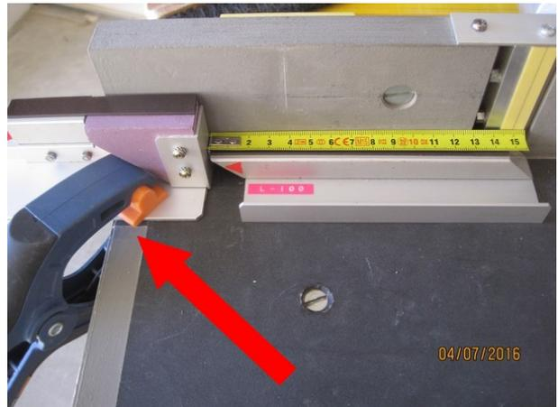
(\*) Avec la nouvelle pince de serrage, on peut descendre à 20 mm. En effet, la largeur de sa tête a été réduite pour permettre un appui au plus près du curseur. Voir sa fabrication en fin de dossier.
