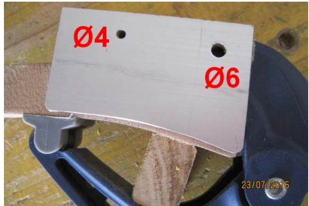
Retourner la pince et percer 3 trous au  $\text{Ø}3,5$  en forme d'arc de cercle sur la partie inférieure. Attention, percer seulement l'aluminium en marquant à peine le bois (régler soigneusement la profondeur de perçage sur la machine).
