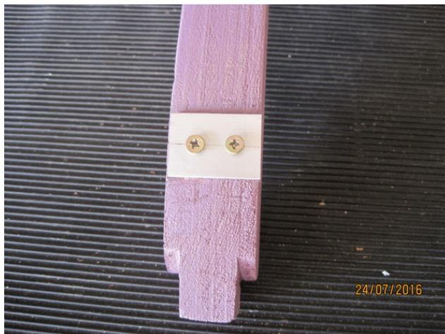
Démonter, puis le visser avec deux petites vis de 2,5x10. L'arrêt est maintenant en place.
