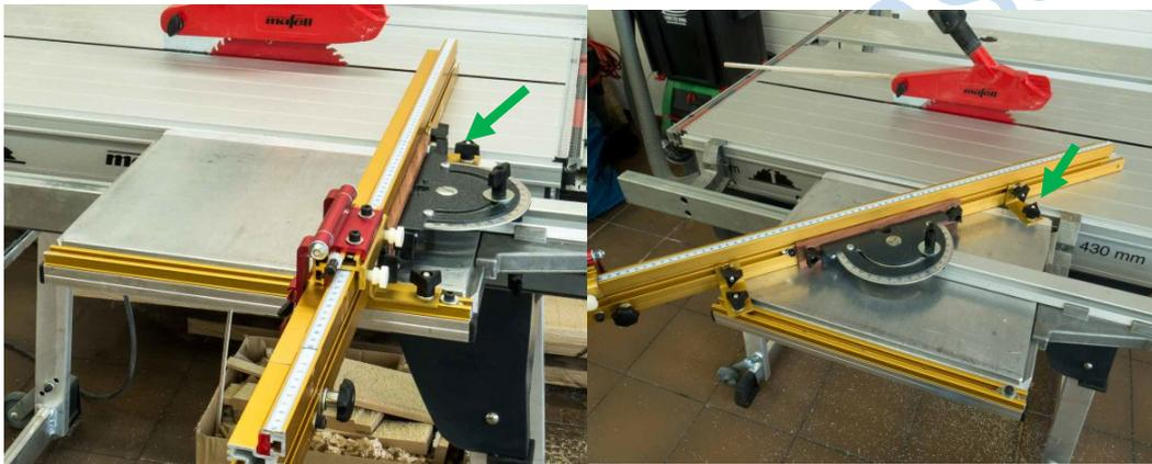
*Photos extraites du blog de Heiko RECH ; la flèche verte indique le point fixe de rotation de la règle-butée sur la table du chariot.*
