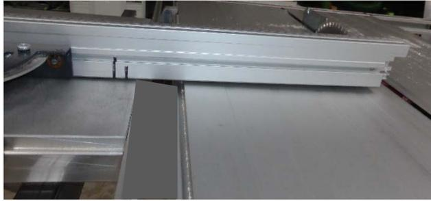
Le sciage est alors inconfortable car il faut se concentrer simultanément sur la parfaite connexion de la pièce à travailler contre la règle-butée et sur l'effort vertical à imposer manuellement à l'extrémité interne (droite) de cette butée pour la maintenir au contact de la table de sciage.
