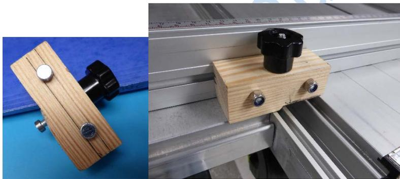
Dans le sens horizontal ce bloc est traversé par deux vis « A » TH M6, L = 40 mm, têtes H meulées en arrondi, qui sont vissées dans des trous taraudés à M6 dans le bois (alésage préliminaire à 4,5 mm) 20 mm au-dessus de la base du bloc.
