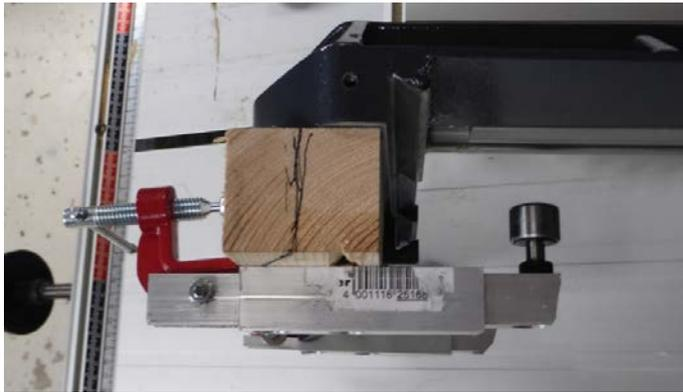
Deux entretoises en bois ( $e = 35$  mm,  $l = 65$  et  $110$  mm) vissées contre le dessous de la platine maintiennent le dispositif à une distance verticale constante du rail, de façon à ce que les roulements passent librement (pas beaucoup d'espace !) sous le débord du plateau de l'ERIKA.
