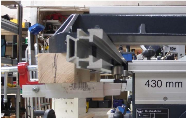
Chacun de ces galets est boulonné sur une glissière horizontale (ici tube carré d'aluminium 15,5 x 15,5 mm). Cette glissière (en vert ci-dessous) se déplace dans un support (tube carré d'aluminium 19,5 x 19,5 mm) fixé sous la platine, perpendiculairement au déplacement de la platine sur le rail 03 86 86.
