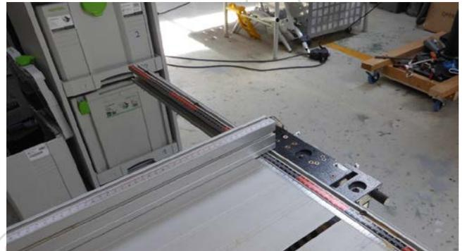
Ce guide, très rigide, a **la grande qualité d'autoriser le montage et le démontage rapide de guides parallèles (DIY) différents, dédiés chacun à une opération bien spécifique** : délignage, délignage avec presseurs (type «Jessem» ou peignes à pression «*featherboard*»), réalisation de rainures, feuillures, épaulements, tenons, mortaises traversantes, ... : cependant il présente **deux inconvénients d'utilisation**.
