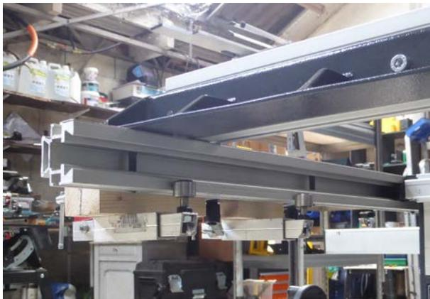
Deux roulements à axe vertical (galets de came à rouleaux ou à aiguilles) viennent s'appuyer contre la partie inférieure de la face arrière verticale du rail support 03 86 86; l'un des galets est placé vers le bord gauche de la platine du guide 03 53 58, l'autre vers le bord droit.
