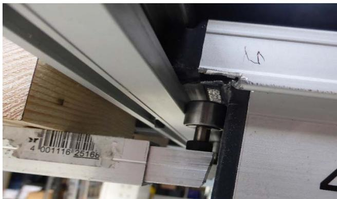
Les galets restent plaqués contre la face arrière du rail grâce à la traction constante exercée par des vis de réglage (moitiés de presse à visser en « C » fixées sur les glissières  $15,5 \times 15,5$  mm) qui viennent s'appuyer contre l'arrière des entretoises en bois.
