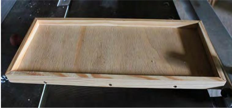
J'ai construit une petite plateforme avec une chute de contre-plaqué.
