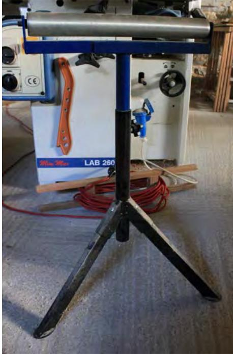
Pour des besoins de délignage et de dégauchissage de planches de grande longueur, j'avais fait l'acquisition de servantes à rouleau.
