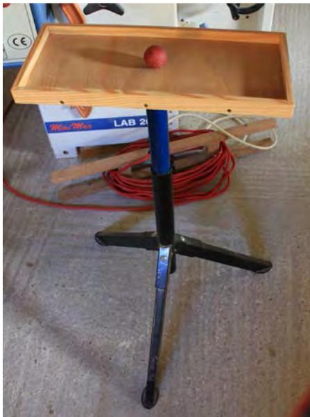
Cette plateforme est fixée au trépied au moyen de deux tiges filetées et vis papillon.
