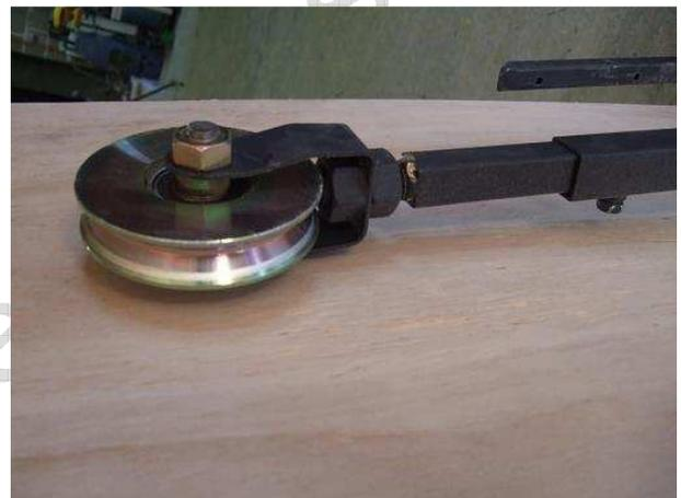
La roulette prend appui sur une barre ronde de 15 mm fixée sur une cornière de 30 x 30x 3. L'ensemble est vissé sur le bâti par des boulons de 8 mm traversant des trous oblongs afin de garantir le parallélisme avec la machine.
