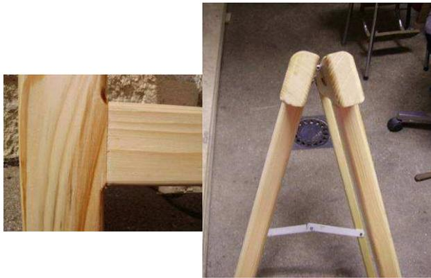
Les éléments du tréteau sont assemblés par collage. Afin de casser tous les angles un quart de rond de 10 mm a été usiné à la défonceuse. Mais sur le dessus de la traverse haute c'est un quart de rond de 20 mm
