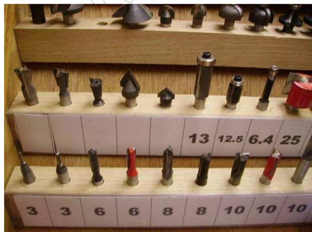
J'ai juste adapté l'intérieur pour recevoir ma petite collection de fraises. Pour cela j'ai pris un tasseau de 30 mm de large et de 40 mm de haut, un trou borgne de 8.5 mm espacé de 30 mm pour fraise a queue de 8 mm, un coin a été raboté avec un angle de 45°, une fois coupé a la largeur intérieure de l'armoire ces tasseaux sont vissés sur le fond par l'arrière. Il ne reste plus qu'à y apposer une étiquette avec le diamètre des fraises droites
