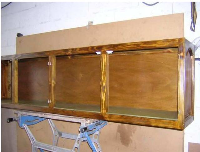
Réalisation et assemblage du bâti à tenon mortaise
