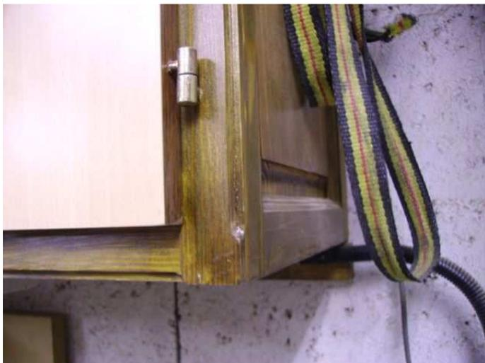
Un congé sur les arêtes, usiné à la défonceuse, affinera l'ensemble
