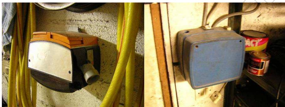
Remplacez la fiche d'origine par une fiche femelle ; attention à ne pas laisser échapper le cordon dans l'enrouleur ! Pour cela, faites provisoirement un nœud. Le moteur qui ne sert pas dans notre système partira à la déchetterie avec les autres éléments inutiles
