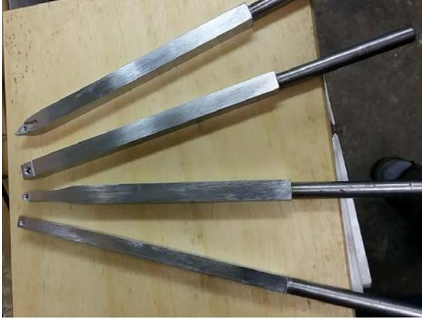
A ma demande un copain a réalisé un jeu d'outils à plaquette carbure dans une tige d'acier de 15x15mm. L'usinage a été fait sur fraiseuse et tour numérique.
