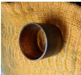
Les viroles sont coupées au coupe-tube dans un tuyau de cuivre écroui (et non recuit) de plomberie (diamètre 30 mm et de 20 mm de long). Je procède ensuite à l'ébavurage. Une extrémité est chanfreinée à l'intérieur avec la lime demi ronde afin de faciliter l'insertion de cette virole.
