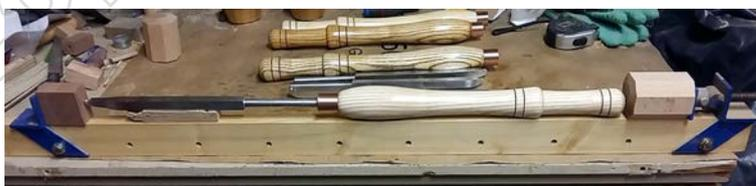
S'il y a besoin de forcer un peu lors de l'insertion, placer l'outil sur un morceau de bois manche en haut et frapper avec un maillet. L'insertion pourra aussi se faire à l'aide d'un serre joint, ou comme sur la photo avec un dormant.
