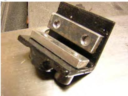
J'ai pris un morceau de cornière dans laquelle j'ai percé quatre trous pour la fixation coulissante sur le rail guide.
