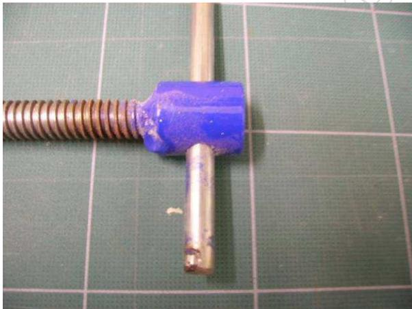
Un morceau de fer rond 30 x 30 mm sera soudé à l'autre extrémité de la tige filetée et percé de part en part au diamètre de 8 mm. Ce perçage assurera le passage de la tige qui recevra un point de soudure à chaque extrémité afin de la maintenir en place
