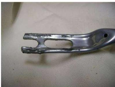
Il suffit de modifier la fixation à l'aide d'une scie à métaux, une perceuse et une lime.
