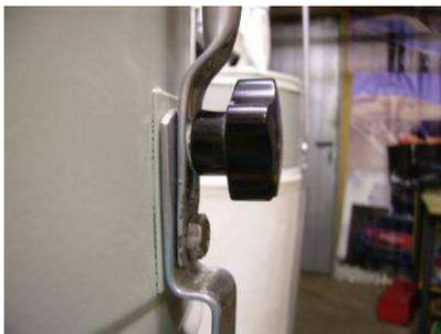
Une vis moletée récupérée sur une vieille chaise de bureau assurera le serrage en position de fonctionnement.
