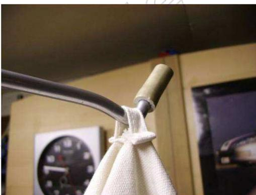
Une autre petite astuce pour éviter que votre sac se décroche pendant qu'il se dégonfle à l'arrêt de votre aspirateur : un bout de tuyau de gaz et hop ça ne bouge plus et ça permet de le décrocher facilement !
