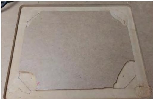
Elargir les angles, retirer le cadre de fraisage, Découper le centre à la scie sauteuse.
