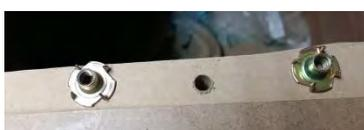
Sous le dessous, des écrous à frapper sont mis en place pour la fixation de l'ensemble sur l'établi.
