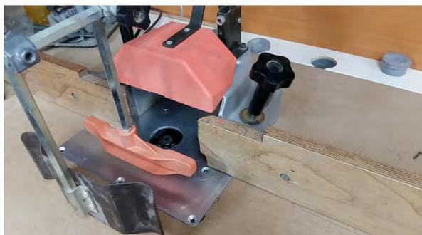
Le guide parallèle d'origine de ma toupie sera aussi utilisé pour la défonceuse sous table. Celui-ci étant équipé de presseurs relevables et de joues réglables au plus près de l'outil.
