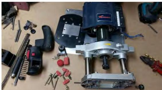
Il faut débarrasser la défonceuse du superflu et tout ce qui peut gêner dans mon montage : poignets, butée de profondeur, semelle pour gagner les quelques millimètres perdu dans l'épaisseur de la plaque, les ressorts (pour retirer l'un des ressorts j'ai dû ouvrir la défonceuse).
