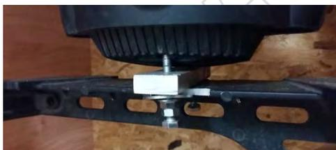
La poussée ne se fera pas directement sur le corps en plastique de la machine car il n'est pas prévu pour cet usage, mais directement sur les vis de fixation. J'ai ajouté une petite plaque avec des vis qui viennent pousser sur celles du carter.
