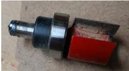
Comme je ne possède pas de fraise à copier, j'ai pris une fraise droite de 22 et j'ai ajouté un roulement de roue de roller (diamètre intérieur 8 mm extérieur 22 mm) ce qui correspond parfaitement à la fraise de 22. J'ai bloqué le roulement avec une bague butée qui sert normalement à régler la profondeur de perçage. Voilà j'avais ma fraise à copier.
