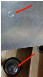
Pour que la vis affleure le dessus de la plaque au bon endroit il faut un perçage précis. J'ai donc remis la plaque en position et j'ai tourné la tige filetée par le dessous ce qui a laissé une trace. Il n'y a plus qu'à percer au centre du marquage au diamètre légèrement supérieur à la tête de vis.
