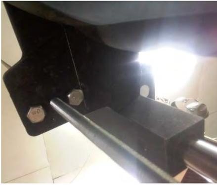
Un morceau de fer plat de 10 mm d'épaisseur percé et taraudé à 7 mm fixé sur la coulisse en aluminium assurera le déplacement de celle-ci.
