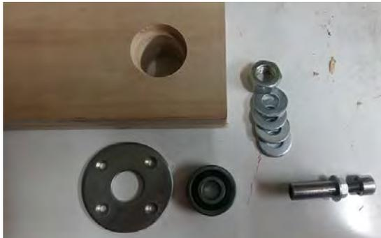
Comme je voulais une montée/descente de la défonceuse qui se fasse par le dessus, j'ai bloqué sur le haut de la tige filetée, un manchon lisse à l'extérieur du même diamètre intérieur que mon roulement. J'ai compensé la différence de hauteur du roulement avec le manchon par un écrou et des rondelles, une vis type six pans creux bloquée à l'autre extrémité du manchon assurera la montée et la descente.
