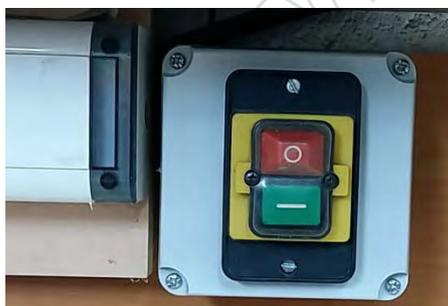
La mise en marche et l'arrêt se fait par l'intermédiaire d'un interrupteur à manque de tension.
