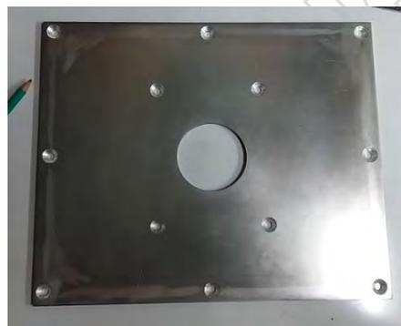
Traçage et perçage au diamètre 6 mm avec fraisage des trous de fixations.
