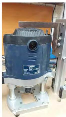
Un système de rail avec un chariot sur roulement provenant d'une table à dessin avec un rail de 1.20 m, il serait dommage de n'utiliser qu'une vingtaine de cm. Ce système pourrait servir à autre chose. Ici un essai avec une équerre à chapeau.
