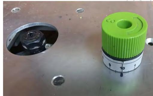
La graduation a été réalisée avec le logiciel de dessin gratuit SketchUp. Je vous propose deux modèles de graduations avec 10 repères pour une tige filetée au pas de 1 mm par tour (à adapter aux matériaux utilisés).
