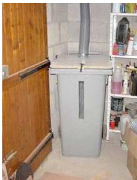
Le joint sur la poubelle est un joint en mousse dense de 15 mm de large (pas facile à trouver). Il est possible de faire un gros cordon silicone qu'on laisse sécher 48 h. Pour la fermeture, j'ai mis des charnières à piano à l'arrière et des grenouillères pour plaquer le tout.
