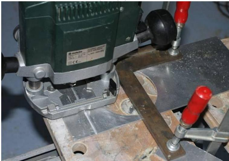
Pour guider la défonceuse lors des fraisages des amorces de pliages, je me suis simplement servi d'une équerre.
