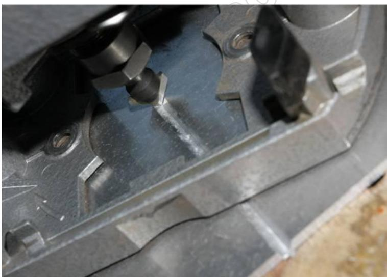
Il y a de chaque coté un rabat qui sert de butée. Pour pouvoir les plier, j'ai fait une rainure en "V" sur environ les 2/3 de l'épaisseur de la tôle. Soit 2 mm environ. Pour cette opération, je vous conseille de légèrement surélever le centre de la semelle de quelques mm avec par exemple du CP collé avec du double face. Ceci pour permettre à la défonceuse de ne pas accrocher les bavures qui ne manqueront pas de se faire de part et d'autre du fraisage.
