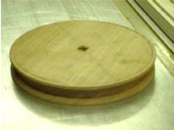
Tourner une « roue » de 10 cm de diamètre, avec une gorge de 10,5 mm de large et 10 mm de profondeur.
