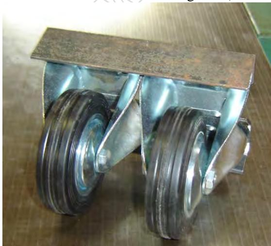
J'ai pris deux roues de manutentions insérées dans des cages d'acier (environ 15 € pièce en GSB). Je les ai jumelées avec deux bouts de cornière d'acier (35x35) et quelques boulons (M8).
